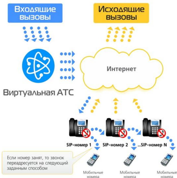
Рисунок 2.1 – Принцип работы виртуальной АТС
