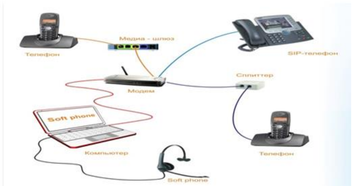
Рисунок 2.10 –Схема подключения SIP-телефона
